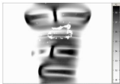
图 2：波纹橡胶管内的气孔
